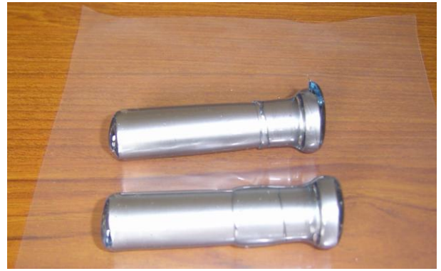
部品を防錆膜(1、5mm以上)で保護
